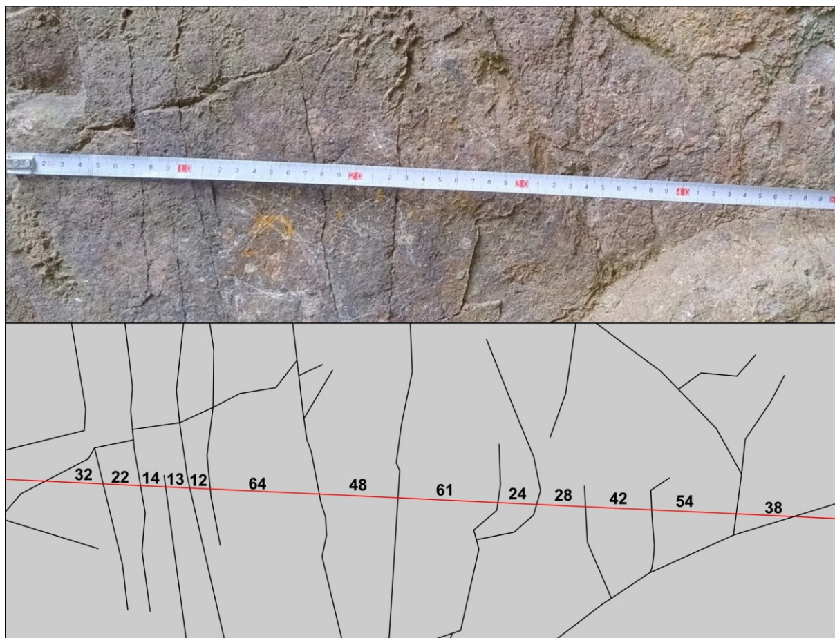
Obr. 4: Terénní mapování puklin (vzdálenost puklin v mm)
