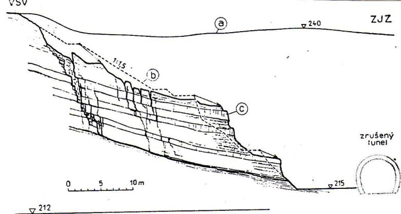
Obr. 10-1. Sesuv na svahu průkopu návrším Bohdalcem v Praze. a – původní povrch území, b – upravený svah výkopu, c – posunutí královských břidelic po vrstevních plochách.
