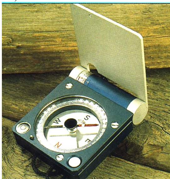
Obr. 9.6 Geologický (hornický) kompas podle Prof. Dr. Clara
