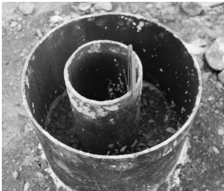
Obr. 6.5 Instrumentace vsakovací zkoušky (podle Nestěreva) na povrchu hutního pole. Průzkum pro VD Slezská Harta
