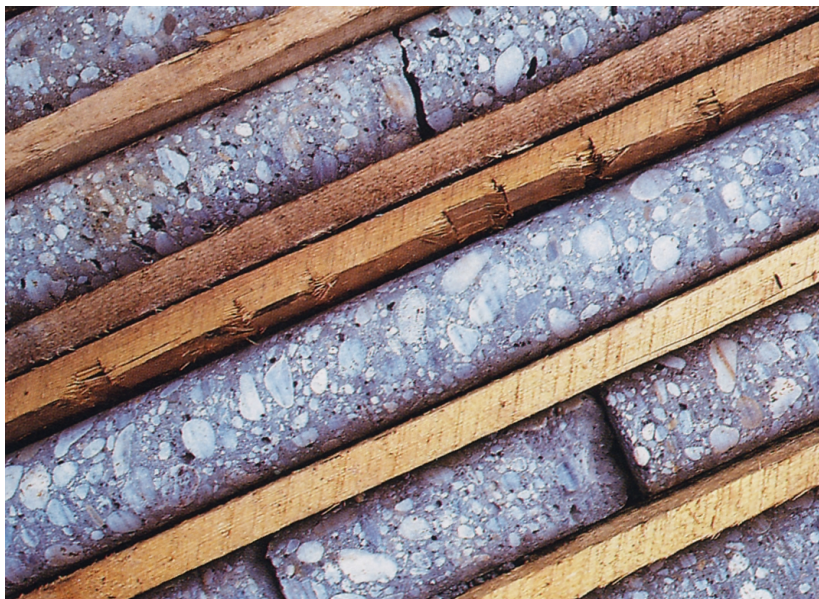
Obr. 5.4 Vrtné jádro uložené ve vzorkovnici. Vrtání v betonu (GEOHYCO a. s. Bratislava)
