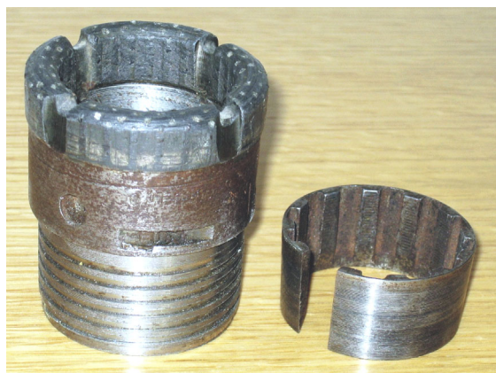
Obr. 4.57 Diamantová jádrovací korunka, trhač jádra (Z. Tkaný, 1966, foto V. Horák)
