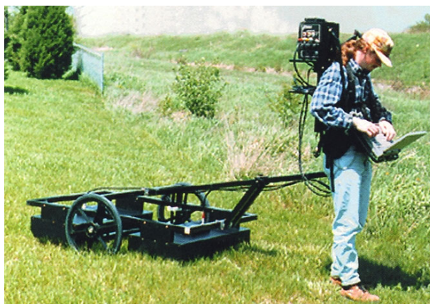
Obr.4.20 Pojízdné georadary (fy Sensors & Software a fy Noggin, Missassauga, Kanada)
