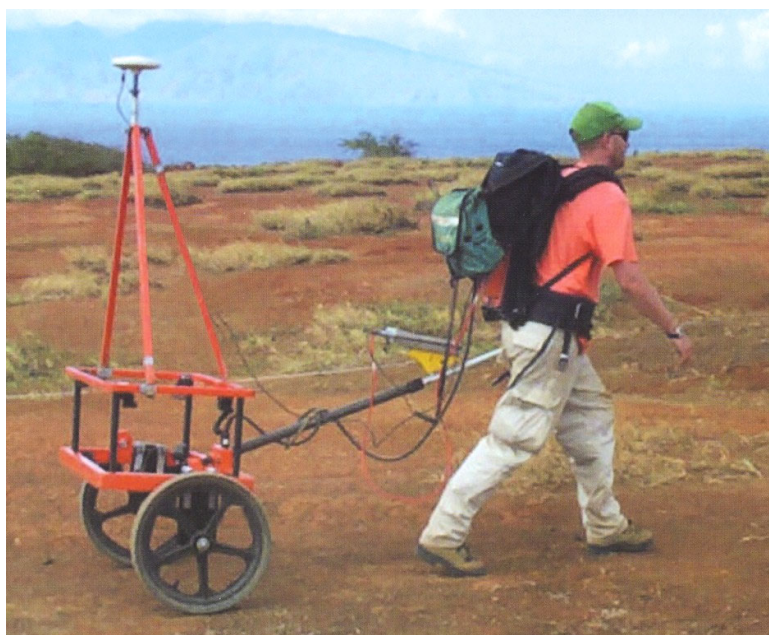
Obr. 4.12 Magnetometr na lehké kolové lafetě (fy Geonics Limited, Missassauga, Ontario, Kanada, 2003)
