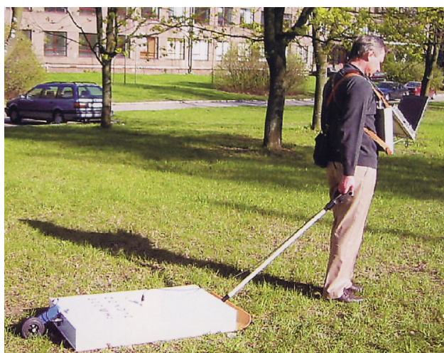
Obr. 4.22 Pojízdný a přenosný georadar (fy RADAR Systems, Inc., Riga, Latvia)
