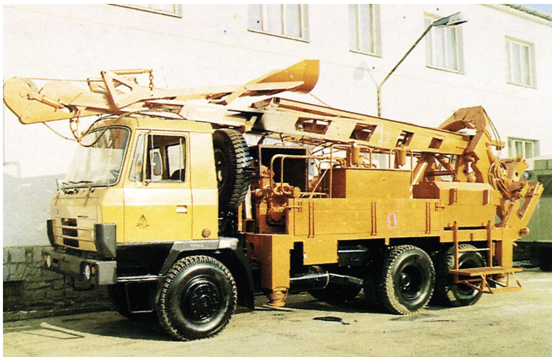
Obr. 4.67 Drapáková vrtná souprava PVSD-R (fy GEOspol, Uhřínov)
