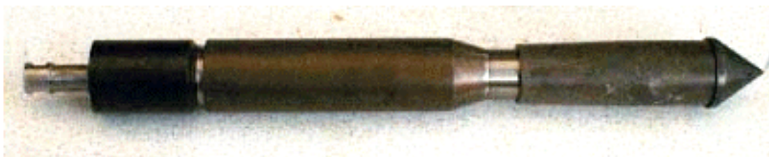
Obr. 4.80 Mechanický (mechanicko-hydraulický) Begemannův hrot pro statickou penetraci
