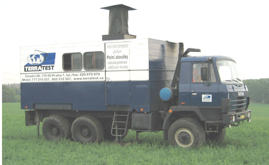
Obr. 4.84 Těžká mobilní statická penetrační souprava. Reakce tlačné síly je zachycena vysokou hmotností nosiče (Foto J. Šmíd)
