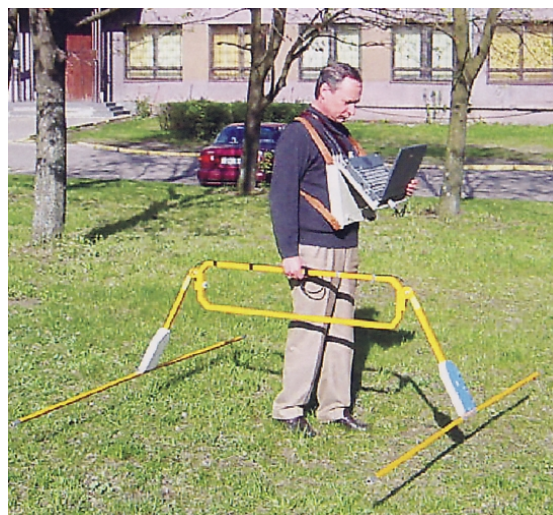
Obr. 4.22 Pojízdný a přenosný georadar (fy RADAR Systems, Inc., Riga, Latvia)
