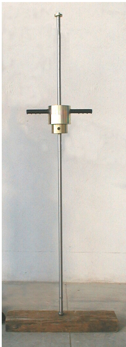
Obr 4.77 Lehká ruční penetrační souprava DPL
