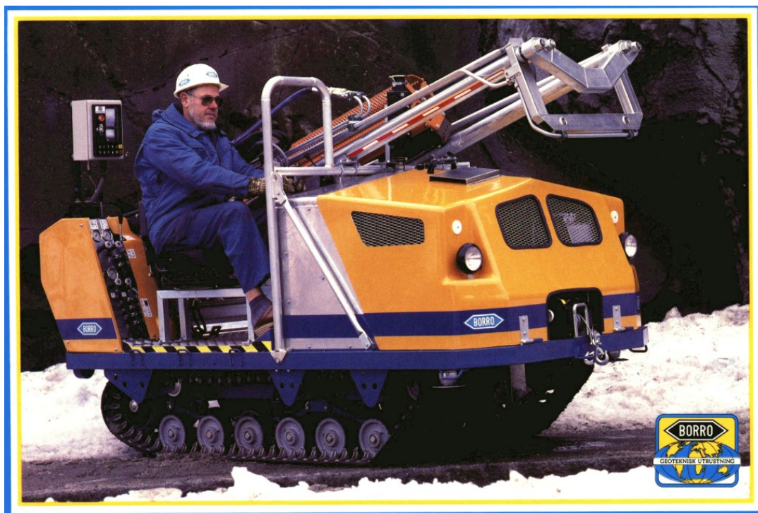
Obr. 4.86 Mobilní statická (a dynamická) penetrační vrtná souprava „POLHYDRILL“ fy BORROS (BORROS AB, Solna, Sweden)
