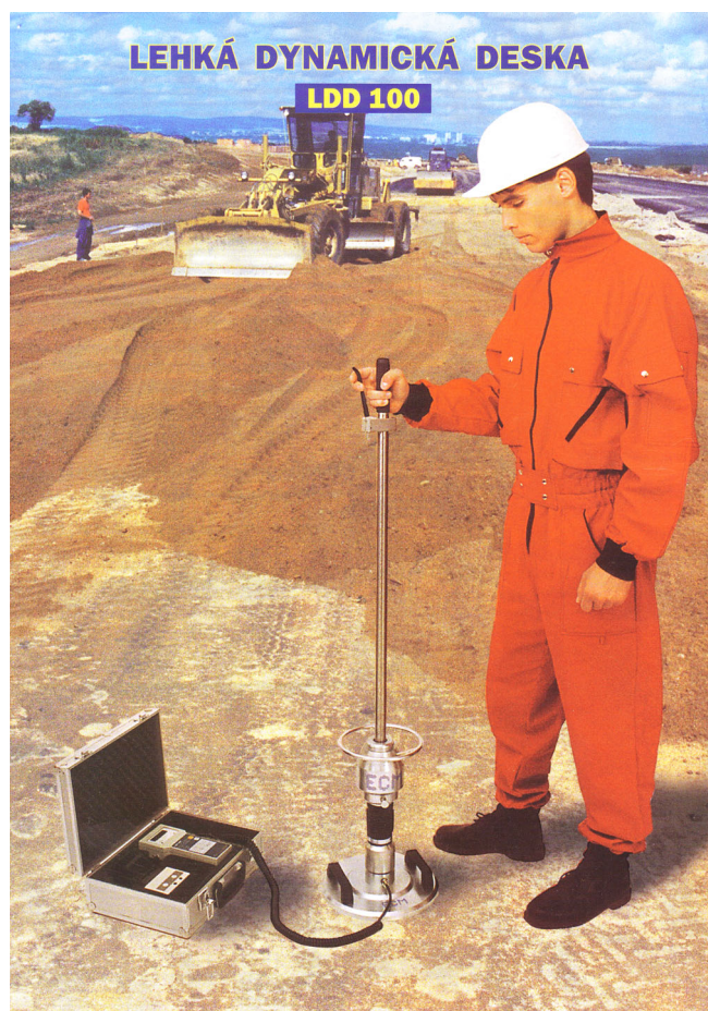
Obr. 11.20 Lehká dynamická deska. Plocha 700 cm 2 , beran 10 kg, výška pádu 1 m (fy ECM, ČR)
